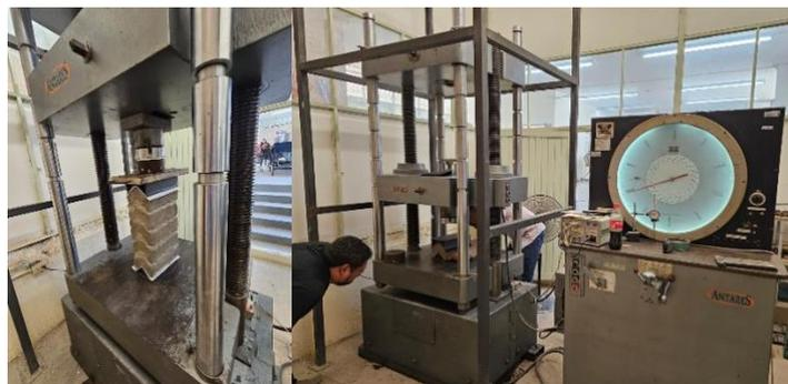
Figura 7. Prueba mecánica a block.
